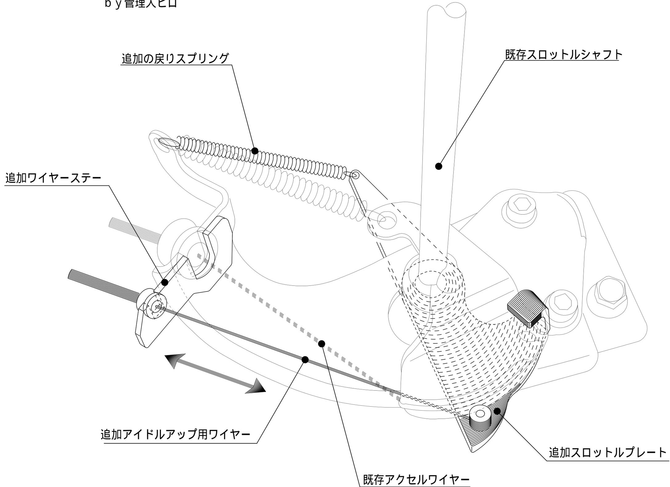
暖機運転目的のアイドル調整用スロットルプレート計画図
